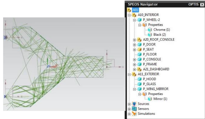
CAD上で光線の振る舞いを可視化。 CADのツリーも利用可能
