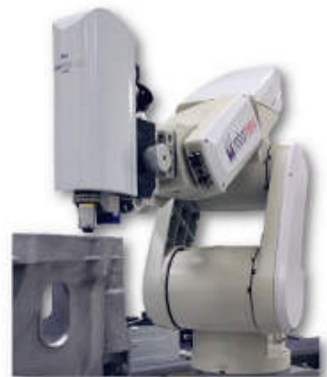
汎用多点自動測定装置 (ロボットティーチング計測)
