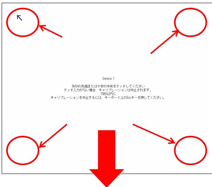
5 ディスプレイがキャリブレーション表示に切り替わります。画面の指示に従って、四隅をタッチする。
