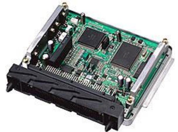
Fig. 車載用コンピュータ(ECU)
