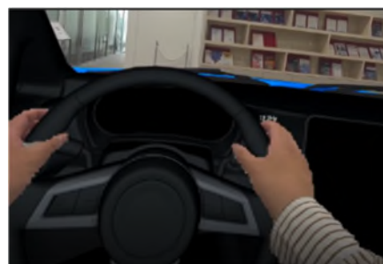
右：オクルージョン処理あり 作業員の手がハンドルの前面に見えるよう、 実際の奥行・距離感が再現される
