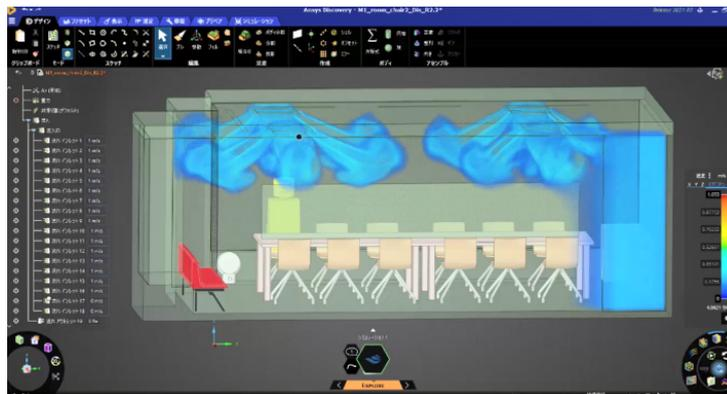
3D 点群データをモデル化し、空調シミュレーションを実施した例
