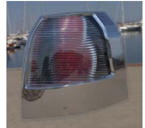
LucidShapeの機能で設計した見た目と光の性能を両立したテールランプ
