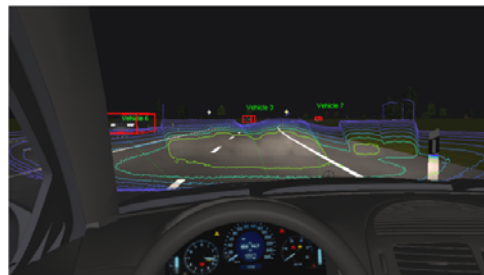
対向車に当る光を遮光している制御を再現
