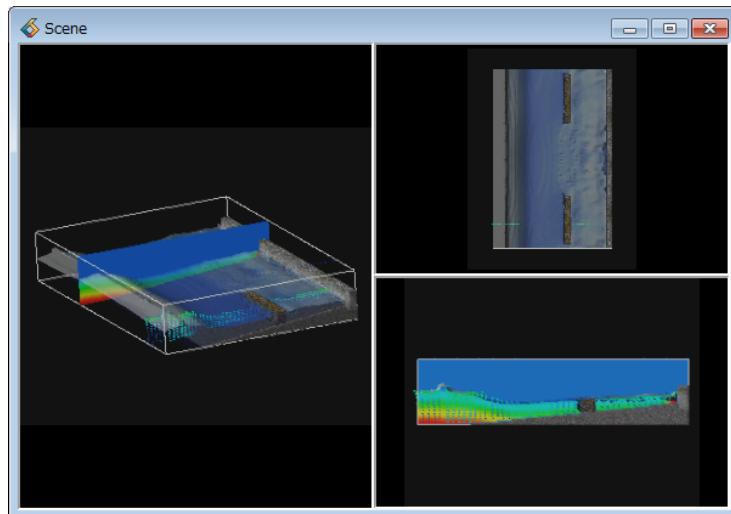
図 4: 障害物による波の干渉シミュレーション
