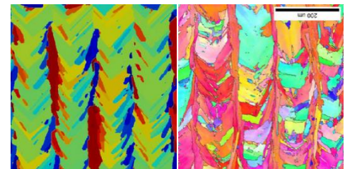
結晶粒の方位 (左: 微細構造解析結果 右: EBSD による測定結果)
