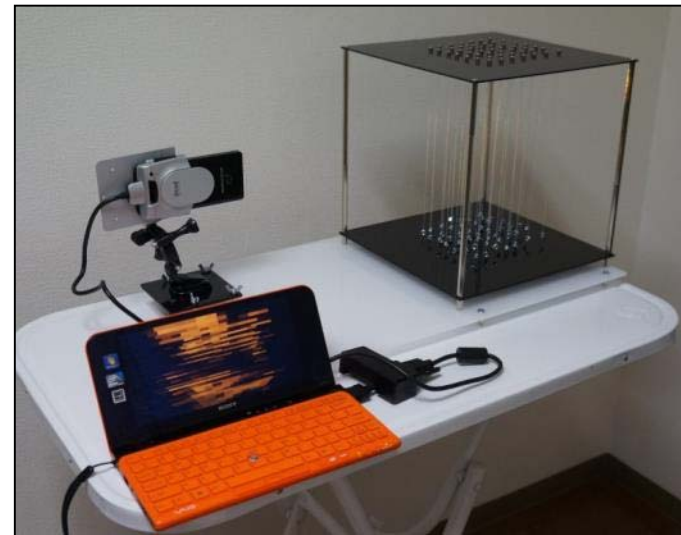
糸とプロジェクタを用いた ボリュームディスプレイ
