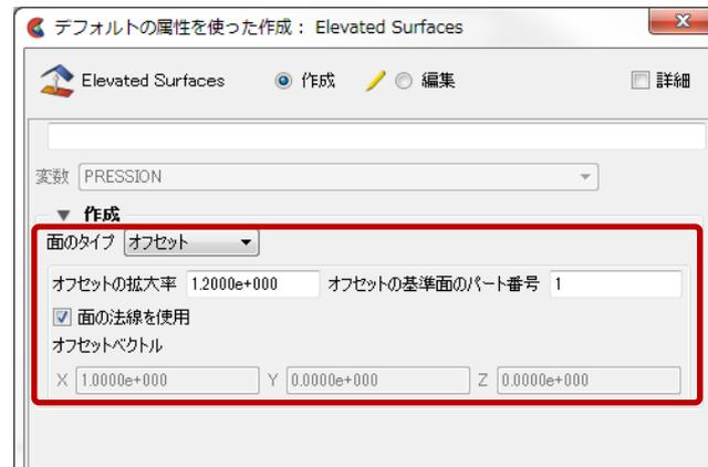
[面のタイプ]は、“オフセット”で設定します。ユーザーの指定方向に指定分だけ浮かせた面を生成します。
