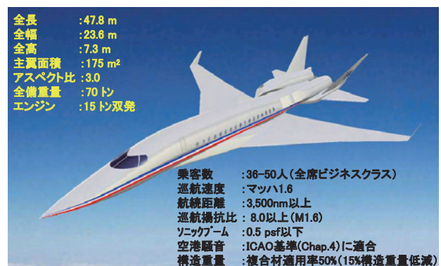
図2 JAXAが想定する小型超音速旅客機概念形状と技術目標
