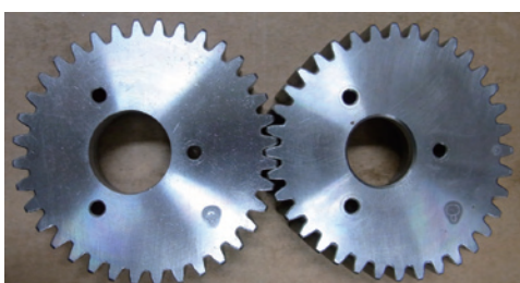
図2 本変速システムに用いる非円形歯車
