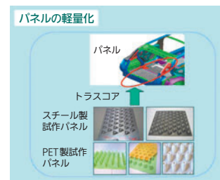
図3 トラスコアパネルによる車体パネルの試作
