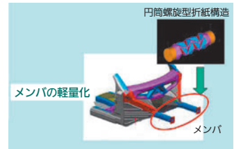
図7 RSCの車体メンバー適用例
