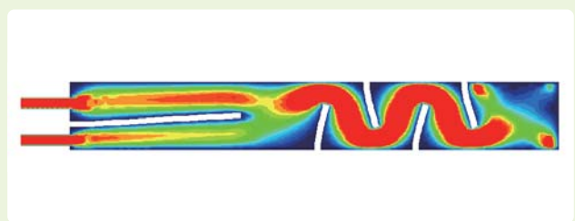
図2.4 充填過程におけるインサート部品弾性変形挙動と樹脂流動(流速)挙動
