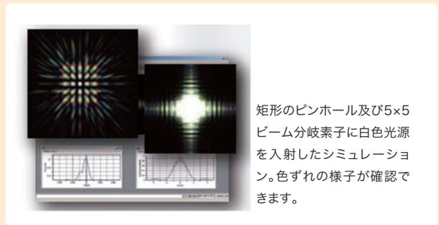
矩形のピンホール及び5×5ビーム分岐素子に白色光源を入射したシミュレーション。色ずれの様子が確認できます。
