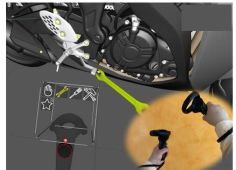
両手で CAD モデルを操作する様子
