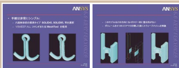
図1a 自動スウィープメッシュ 図1b ボリュームを分割してのスウィープメッシュ分割
