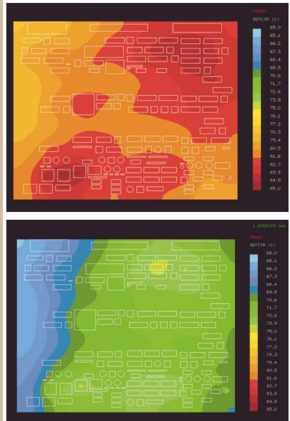
図2 初期状態のプリント基板(上)と左下コンポーネントにヒートシンクをつけ、左右から1m/sの風を流したときの30分後の温度分布(下)
