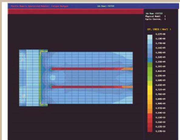
図3 コンター図で表したプレート/スルーホール部分の熱疲労の様子
