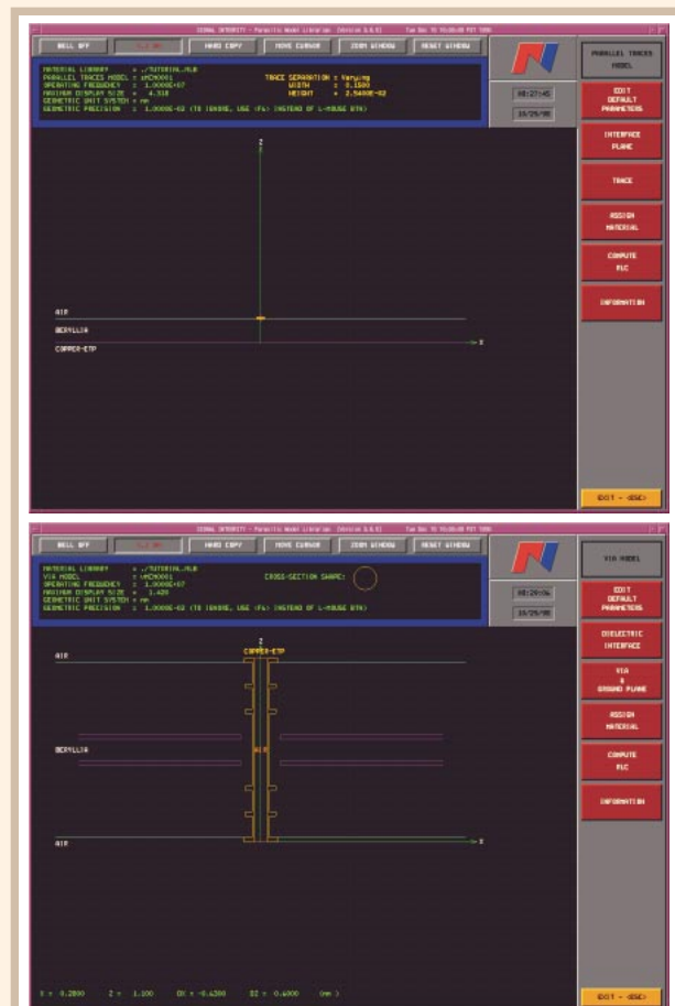
図5 トレースのモデリング(上)とビアのモデリング(下)
