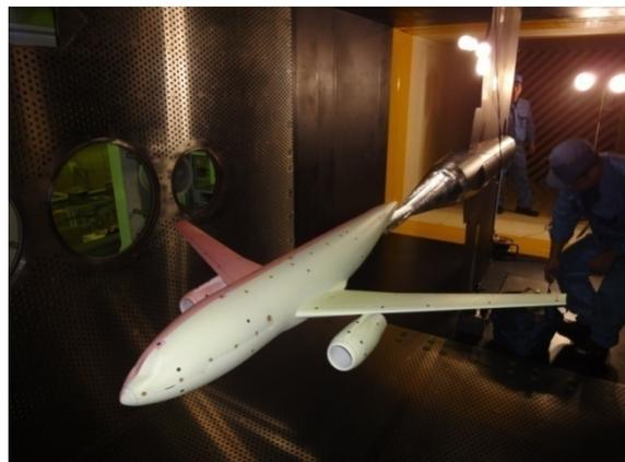
DLR-F6 PIV/PSP/模型変形計試験
