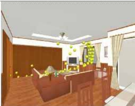
図 11 建築 CAD と AVS のパーティクルトレースとのリアルタイム合成
