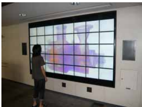
Fig. 6 タイルド表示装置を使った分散PBVRシステム概要
