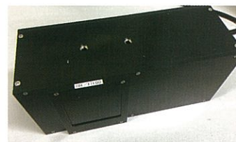
3 LaseView-LHB-miniの外観図 (NDフィルターを付けた状態)
